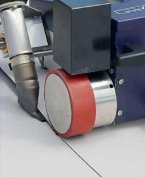
Nozzle las ekstra lebar 40 mm memenuhi standar konstruksi atap internasional.
